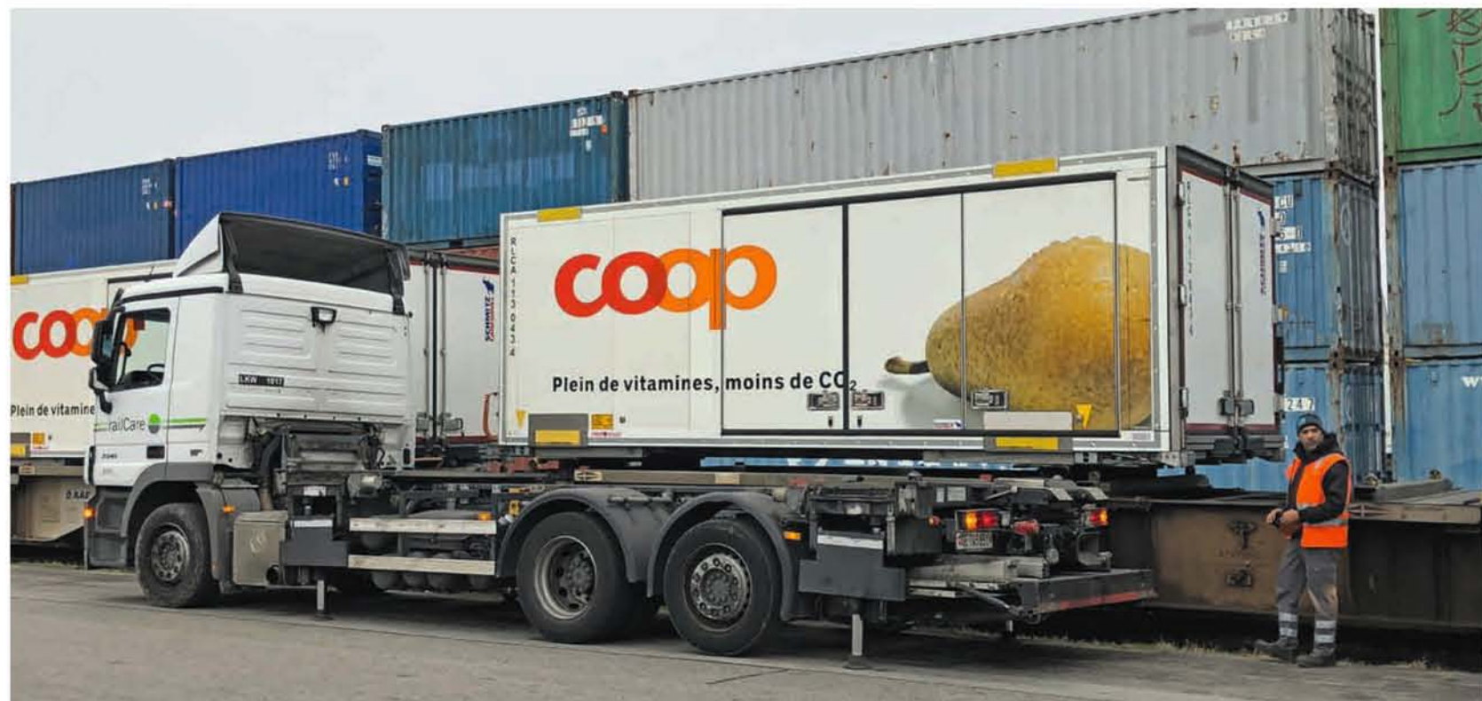
Der Fahrer regelt alles selbst: Im Coop-Verteilzentrum in Aclens werden die Spezial-Wechselbehälter horizontal auf Waggons verschoben. Nach Genf geht's dann per Bahn weiter.
