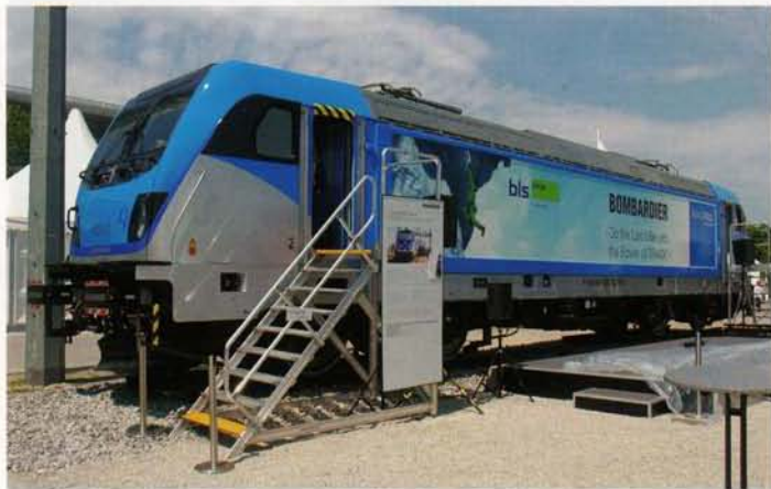
Die erste Bombardier-Traxx F140 AC last mile (mit Hilfsdieselmotor für den Rangierdienst) als 187 001 für Railpool an der Transport Logistics-Messe in München am 11. 5. 2011.
