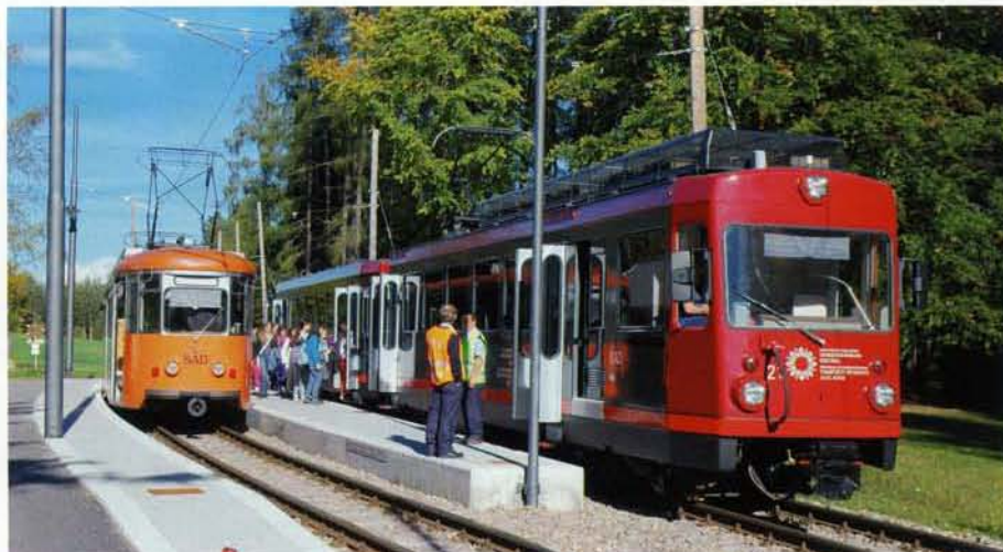
Zugskreuzung auf der Rittnerbahn in der einzigen Zwischenstation Lichtenstern am 6.10. 2010: links der Triebwagen ex Esslingen–Nellingen–Denkendorf (Baujahr 1958, auf dem Ritten seit 1982), rechts der Be 418 21 ex Trogenerbahn (1975 bzw. 2009). Die Wagenführer haben die Warnwesten getauscht, denn diese dienen wie ein Zugstab als «Zugsicherungssystem». Fotos: J. Lüthard
