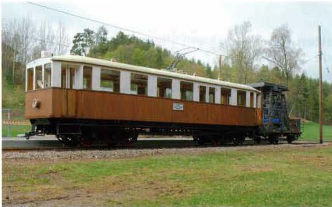
Der Original-Rittnerbahn-Motorwagen 2 von 1907 wartet mit dem Turmwagen am 28.4.2009 in Lichtenstern. Der Lyrabügel war damals noch nicht mit einem Kohlschleifstück versehen.
