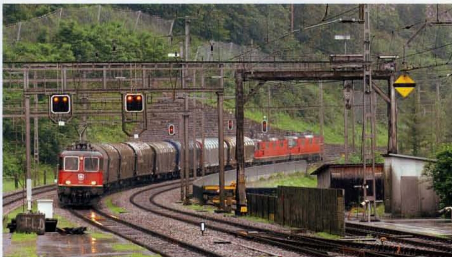
Schienen-Entrostungszug Erstfeld–Göschenen retour mit 3 Re 4/4 II und 9 CFL-Shimms auf der Talfahrt eingangs Amsteg-Silenen am 2.7.2012. Foto: J. D. Lüthard
