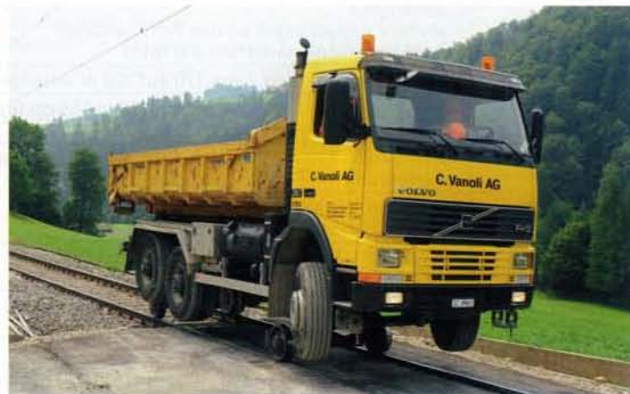
Beim dreiachsigen Lastwagen wird am 4. 7. 2012 auf einem behelfsmässigen Übergang unterhalb des Wilzingen-Tunnels das Normalspurfahrwerk ausgefahren.
