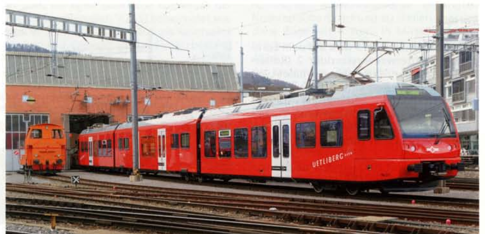
Der erste SZU-Be 556 (2'Bo' Bo'2') kam am 9. 4. 2013 erstmals für einige Tage zur künftigen Eigentümerin. Angeschrieben ist als Kurzbezeichnung Be 511, als Typenbezeichnung Be 510, die TSI-Nr. lautet 94 85 7 556 511-4 CH-SZU. Depot Giesshübel, 10. 4. 2013. Links die Em 236 507 (SIG, Saurer, BBC, 1961). Foto: J. D. Lüthard
