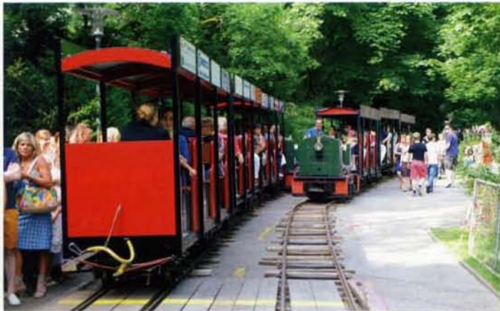
Zum Züri-Fäscht 5.–7.7.2013 gehörte wiederum eine Feldbahn mit 600 mm Spurweite des Vereins der Feld- und Werkbahn-Freunde: Auf einer 750 m langen Strecke zwischen Schanzengraben und Hafen Enge mit einer Kreuzungsstation in der Parkanlage Arboretum verkehrten 2 Züge mit je einer Lok RL 1a (O&K 1931 bzw. 1937, 11 PS). Foto: J. D. Lüthard Pour la fête de Zurich (5.–7.7.2013) il y avait de nouveau une voie Decauville (écartement de 600 mm) de l'association des amis des trains Decauville: 2 trains, tractés chacun par une loc RL 1a (O&K, 1931 resp. 1937, 11 CV) circulaient sur un parcours long de 750 m entre le Schanzengraben et le port d'Enge avec une station pour le croisement dans le parc Arboretum.
