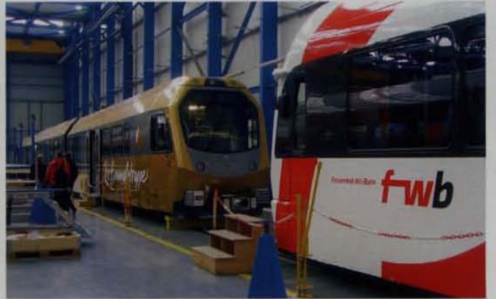
2 massgeschneiderte Spezialausführungen von Stadler im Werk Bussnang am 14.6.2013: ein FW-ABe 4/8 (Meterspur) und eine «Himmelstreppe» für die Mariazellerbahn (760 mm) der NÖVOG. Foto: H. Hug Le 14.6.2013, 2 exécutions spéciales sur mesure à l'usine Stadler de Bussnang: une ABe 4/8 FW (voie métrique) et une «échelle menant au ciel» pour le chemin de fer de Mariazell (760 mm) de la NÖVOG.
