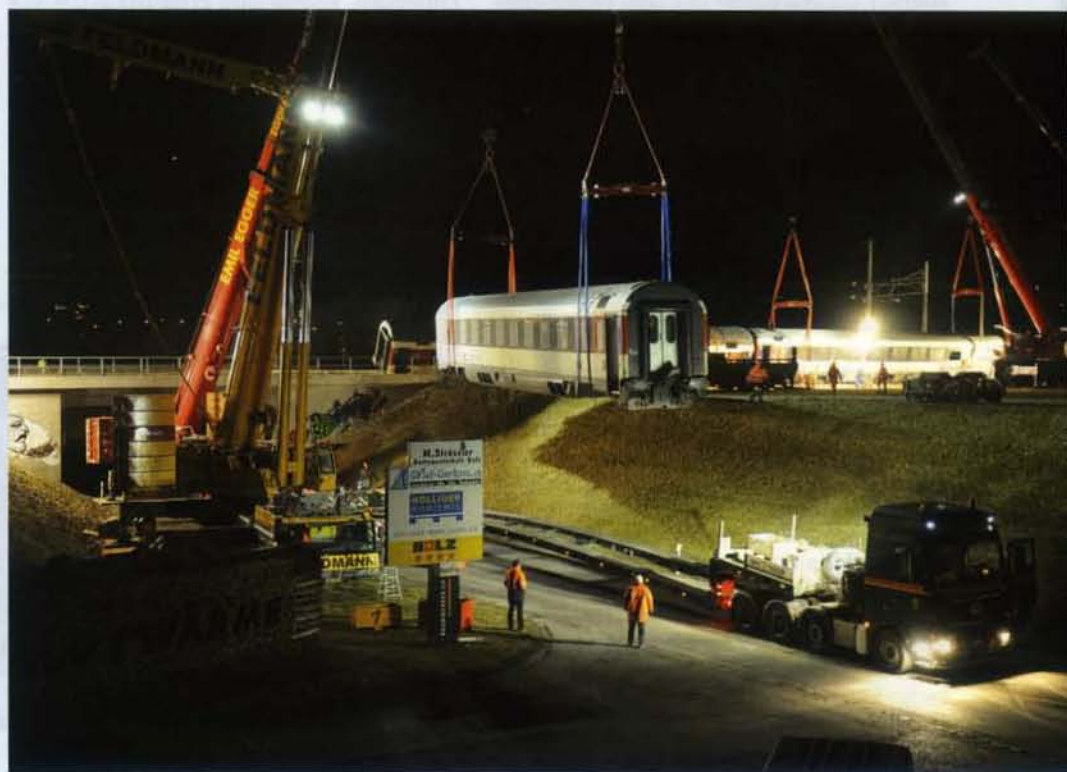
Bergung und Verlad des Kastens des Bpm EC 20-90 271. 20.2.2015. Foto: J.D. Lüthard
