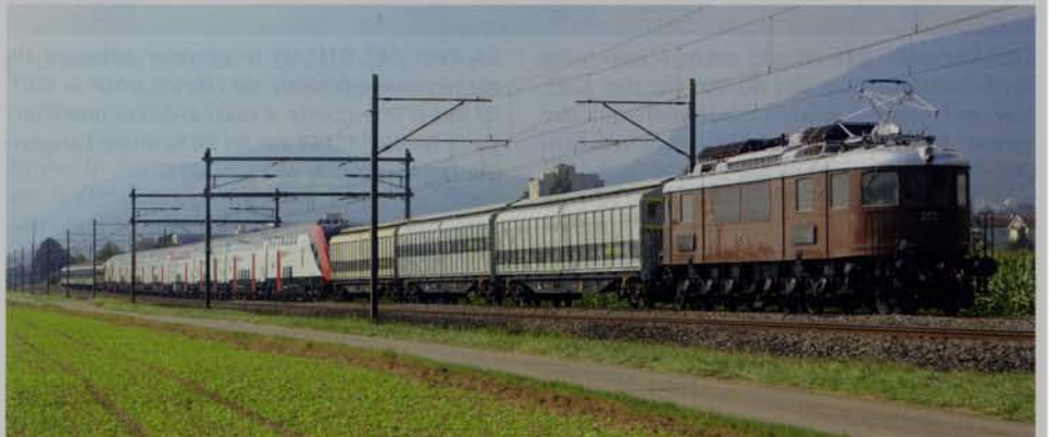
Die Ae 6/8 208 von Swisstrain (ex BLS, Baujahr 1943) überführte am 21.9.2016 den fabrikneuen RABDe 502 004 von Villeneuve nach Basel zur Weiterfahrt Richtung Tschechien. Mit dabei waren 4 Habfis von RailAdventure als Brems- und Kupplungsübergangswagen sowie am Schluss 4 SBB-B 21-73 als Bremswagen (bis Basel). Bei Selzach. Foto: S. Gygax
