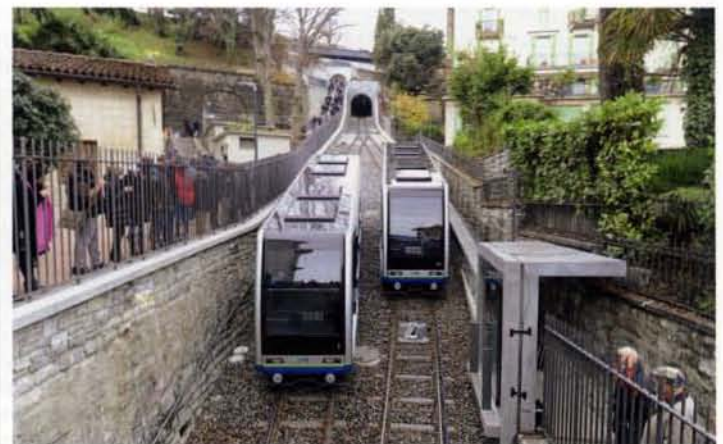
Abtsche Ausweiche mit der Haltestelle Cattedrale am ersten Betriebstag der modernisierten Standseilbahn, 11.12.2016. Foto: J.D. Lüthard
