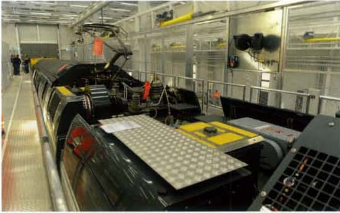
Die neue Serviceanlage Pünten ist für die Wartung der im Dachbereich montierten Apparate der RABe 511 eingerichtet (links) und verfügt über eine Drehgestellsanlage (rechts). Fotos: J. D. Lüthard
