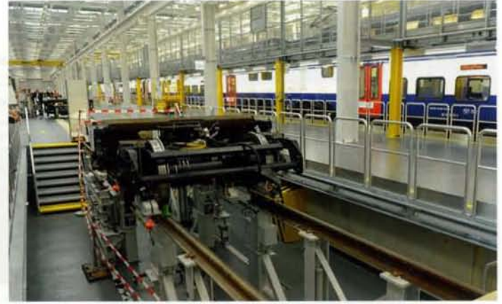
Le nouveau site de maintenance de Pünten (près d'Oberwinterthur) est équipé pour l'entretien des appareils montés sur le toit des RABe 511 (à gauche) et dispose d'un dispositif pour l'abaissement des bogies (à droite).
