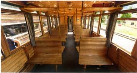
Das Innere eines der selbst aufgebauten Personenwagen. Beachtenswert die versenkbaren Seitenfenster mit Lederriemen.
