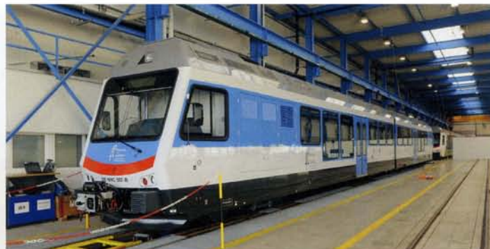
Der zweite von zwei nachbestellten Adhäsions-Zahnrad-Diesel-Doppeltriebwagen DE M4C 500 von Stadler für die Strecke Cosenza–Catanzaro Città–Catanzaro Lido (Spurweite 950 mm) der Ferrovio della Calabria (FC) im Inbetriebsetzungswerk Erlen am 9.9.2020. Foto: J. D. Lüthard La deuxième et dernière rame diesel à adhérence et à crémaillère Stadler DE M4C 500 de la commande supplémentaire de la Ferrovio della Calabria (FC) pour la ligne Cosenza–Catanzaro Città–Catanzaro Lido (écartement 950 mm) au centre de mise en service d'Erlen le 9.9.2020.
