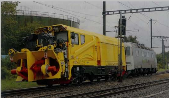
Die zweite Schneefrässchleuder 99 74 9491 002 von Matisa und Zaugg für Trafikverket wird am 5.10.2020 von der RADVE-Re 620 003 von Bussigny nach Basel RB gebracht; die äusseren Frästrommeln wurden für die Überführung abgenommen. Boudry. Foto: C.-A. Fluckiger
