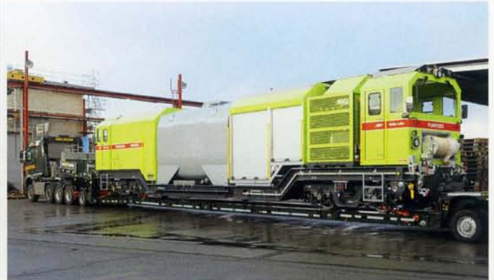
Tanklöschfahrzeug Xm 2/4 27401, das erste Fahrzeug der beiden neuen RhB-Lösch- und Rettungszüge für den Vereinatunnel, auf dem Gelände des Herstellers Müller Technologie in Frauenfeld am 22.2.2022.
