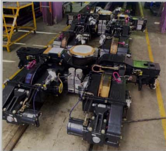
Le bogie de présérie EV 18 sur une voie à écartement métrique. Chernex, le 20.1.2019.
