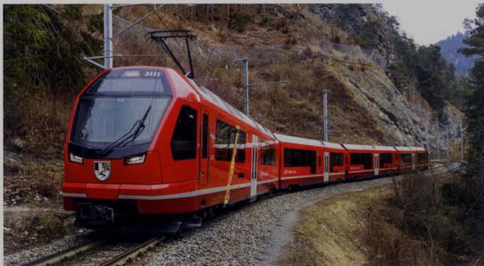
Mit dem RhB-ABe 4/16 3111, dem ersten Capricorn, wurden am 7.3.2023 Messfahrten zwischen Chur und Untersax auf der 60% steilen Arosabahn durchgeführt. Im Regelbetrieb sind sie auf bis zu 45% steilen Strecken (im Prättigau) unterwegs. Foto: G. Trüb
