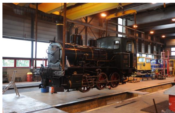
In der Halle der Firma SERSA in Hinwil konnte die Krananlage benützt werden. An Stelle der Puffer wurden extra angefertigte Supports montiert. (Foto: J. Lüthard, 25. Aug. 2011)
