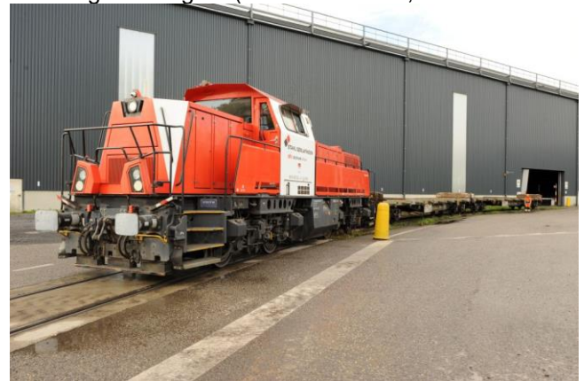
Eine der beiden neueren Dieselloks des Typs Gravita 10 BB. (Foto: J. Lüthard, 22.09.2023)
