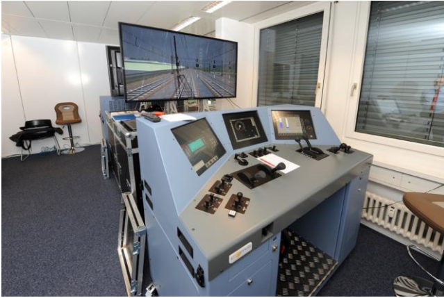
Die beiden zerlegbaren mobilen Simulatoren mit dem Einheitsführerstand. Auf den drei Touchscreen-Monitoren lassen sie die diversen Varianten anzeigen. Erkennbar die zum Transport verwendeten Flightcase. (Foto: J. Lüthard, 21.05.2015)
