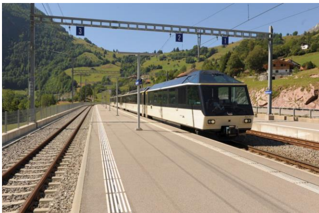
Ein Pendelzug ab Zweisimmen erreicht Montbovon, geführt ab dem Steuerwagen Ast 117. Durch die schlanken Frontholmen und den erhöhten Führerstand, ist eine hervorragende Sicht nach vorne möglich. (Foto: J. Lüthard, 23.08.2022)
