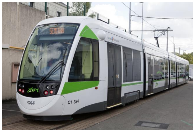
Interessant werden wird, wie sich der über 5,8 m lange Überhang auf die Gleise auswirken wird. Gut erkennbar, dass vor der eigentlichen Wagennummer immer auch der Kastenteil nummeriert ist. (Foto: CAF, 24.04.2012)
