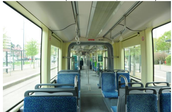
Das Innere der Incentos. Links über dem Fahrwerk die Eineinhalbsitze. (Foto: J. Lüthard, 14.04.2012)
