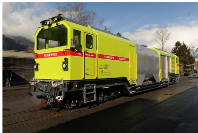
Von der Zugänglichkeit her und mit den strassenbündigen Gleisen eignet sich für den Ablad der weitläufige Bahnhofsvorplatz von Untervaz-Trimmis besonders gut. Von vorne in Fahrrichtung Tunnelausgang, Führerstand, Mannschaftsraum, Wassertank, Geräteschränke, Motorraum, Führerstand. (Foto: J. Lüthard, 22.02.2022)
