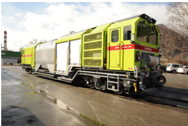
Das Löschfahrzeug Xm 2/4 27401. Gut erkennbar vorne die Schlauchhaspel in Fahrrichtung Tunnelmitte. (Foto: J. Lüthard, 22.02.2022)
