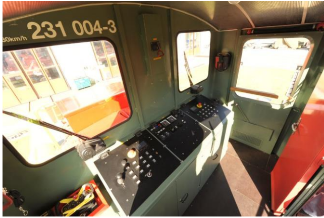
Der erneuerte Führerstand. Links ist die tragbare Funkfernsteuerung zu erkennen. (Foto: J. Lüthard, 02.09.2022)
