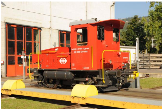
Im Werk Biel der umgebaute Traktor Taf 98 85 5 231 004-3. Gut erkennbar die Ladesteckdose. Eine Designpreis wird der Traktor wohl nicht gewinnen. (Foto: J. Lüthard, 02.09.2022)
