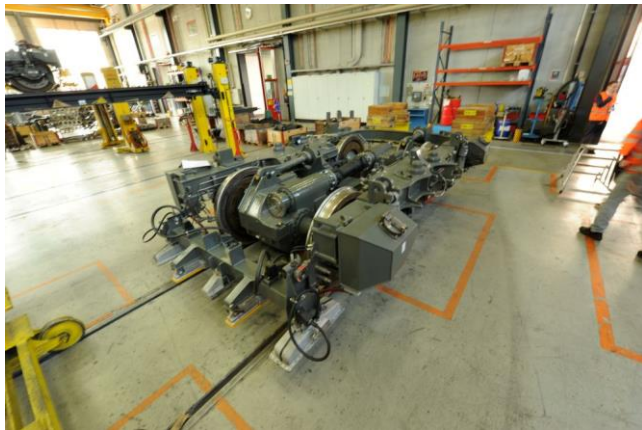
Im Werk Biel ein frisch revidiertes Drehgestell für eine Am 843. (Foto: J. Lüthard, 02.09.2022)
