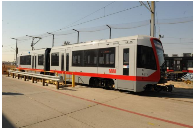
Siemens erhielt als grösster Nahverkehrsauftrag in den USA 2014 von Muni in San Francisco eine Bestellung über 175 LRV vom Typ S200 SF. Zusätzlich bestehen Optionen über weitere 85 Fahrzeuge, aus denen bereits 40 Wagen 2015 zur Bestellung gelangten. Die Ablieferung begann nun, hier der Wagen 2008. Die sehr grossen Freiräume um die Drehgestelle sind durch die engen Kurvenradien bedingt. (Foto: J. Lüthard, 18.10.2017)
