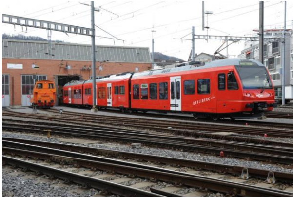
Der erste neue Triebzug Be 4/8 556 511 vor der Werkstätte Giesshübel. Auf einer seiner ersten Fahrten im Bereich der SZU ist der Stromabnehmer an die seitliche Gleichstromfahrleitung mit 1200 V angelegt. (Foto: J. Lüthard, 10.04.2013)
