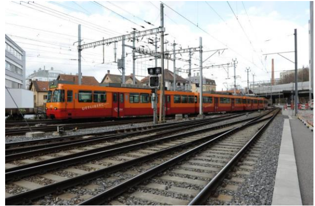
Die Be 8/8 31 + 32 im Bahnhofsbereich Giesshübel. Die teilweise umschaltbare Fahrleitung im Kreuzungsbereich der Bahnen ist sehr aufwändig. (Foto: J. Lüthard, 10.04.2013)
