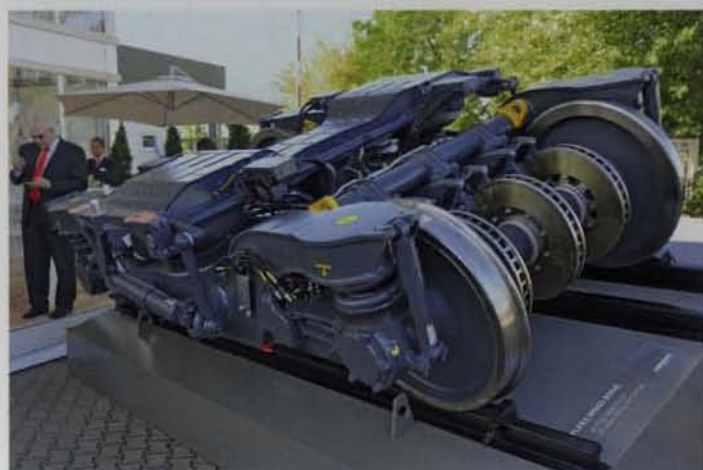
Drehgestell „Flexx Speed“ von Bombardier für den Hochgeschwindigkeitsverkehr mit bis zu 380 km/h (Foto: M. Rellstab).
