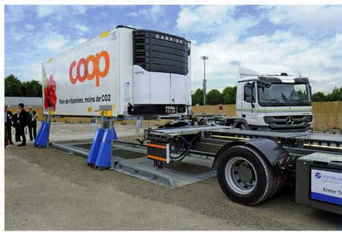
Unten: Umschlag eines Coop-Wechselbehälters vom Güterwagen auf das Terminalfahrzeug (links; Foto: M. Rellstab) und Zwischenlagerung in der „Container Station“ (rechts; Foto: J. Lüthard).
