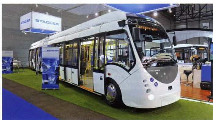
Oben: Der in Minsk gebaute Trolleybus „Vitovt Max Duo 43303A“ mit Diesel-Hilfsantrieb am Stadler-Stand. Am Bus selbst findet sich aber kein Hinweis auf den Schweizer Hersteller (Foto: J. Lütthard).
