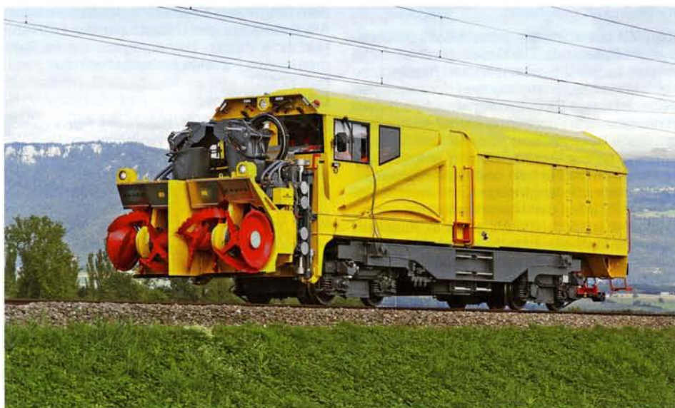
Oben: Die für Trafikverket bestimmte Zaugg-Schneefräscher bei einer der mit bis zu 80 km/h durchgeführten Bremsprobefahrten am 3. September 2015 auf der Strecke Yverdon – Lausanne bei Chavornay (Foto: J. Weibel).
