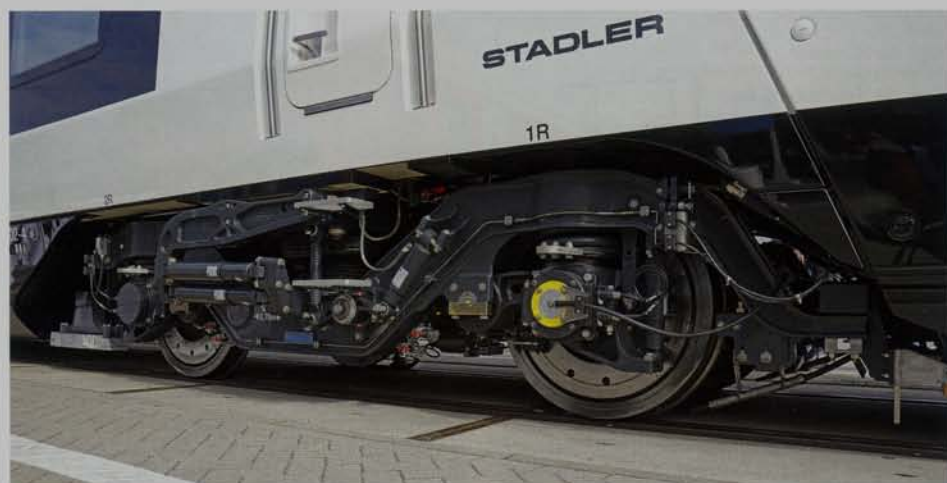
Links Mitte und unten: Konventionelles Drehgestell im Endwagen sowie Jakobsdrehgestell zwischen zwei Wagen des Giruno (Fotos: A. Gerber).
