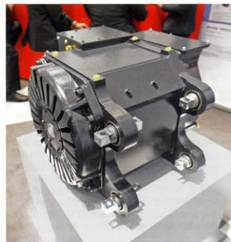
Unten: Der im Giruno eingebaute Fahrmotor TMF 50-33-4 von Traktionssysteme Austria leistet bei einem Gewicht von 710 kg 600 kW (Foto: J. Lüt-hard).
