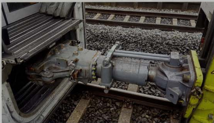
Links: Adapter zum Kuppeln von ICE-1/2-Mittelwagen mit dem Railadventure-Zwischenwagen. Hauptluftleitung und Hauptluftbehälterleitung sind in den Adapter integriert und werden automatisch mitgekuppelt (Foto: 6035).
