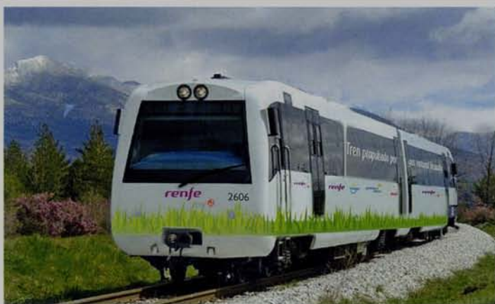
Der spanische Doppeltriebwagen 2606/2605 als Versuchsträger bei Collanzo in Asturien. Die vordere Hälfte wird von einem Dieselmotor, die hintere von einem Flüssiggasmotor angetrieben (Foto: RENFE).
