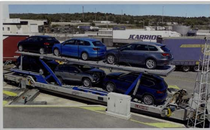
Links: Der neu entwickelte Lkw-Aufleger für Autotransporte auf einem Lohr-UIC-Wagen (Foto: Lohr).
