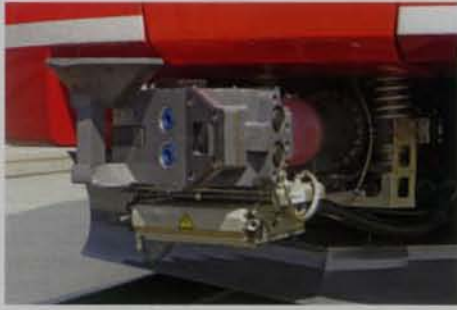
Die vollautomatische Kupplung von Schwab/Faiveley bildet die Basis für den von der RhB angestrebten Flügelzugbetrieb im Prättigau (Foto: M. Rellstab).
