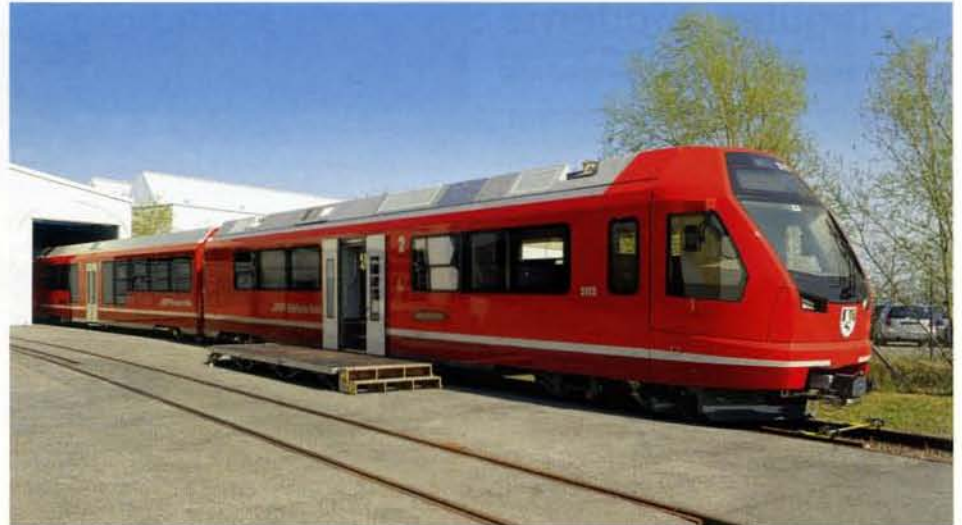
Hochfluriger Triebwagen und Mittelwagen mit Niederflurbereich. Die RhB zeigte in Altenrhein den ABe 4/16 3112, um die Inbetriebsetzungsphase des ersten Zuges 3111 nicht unterbrechen zu müssen (Foto: J. Lüthard).
