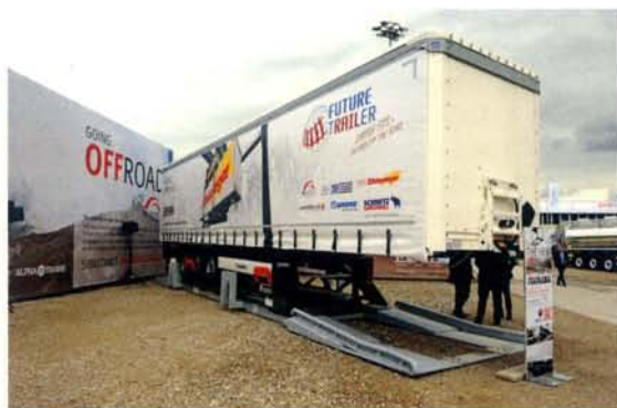
Der erste Future Trailer nach den für den Bahntransport vereinheitlichten Außenmaßen, auf einer Palette des KV-Systems NIKRASA . © Jürg D. Lüthard
