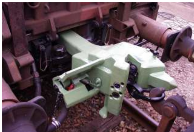
Die C-AKv in Kombination mit der Schraubekupplung, die Puffer liegen an. Die Leitungskupplungen sind in die Klauen selbst eingelassen. Die Leitungen werden an zwei Stellen verbunden, oben Elektro-Steuerleitungen und unten die Hauptluftleitung. Foto: Faiveley.
