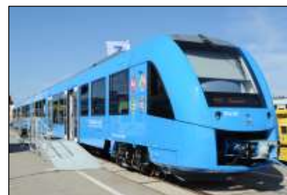
Der weltweit erste Triebzug mit Brennstoffzellenantrieb „Coradia iLINT“ wurde von Alstom vorgestellt; Foto Jürg D. Lüthard.
