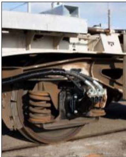
Stützen der Antriebswelle des neuen „RCE-Powerpack“ Waggons von der Firma Rail Care. Foto: Ruben Wyttenbach.
