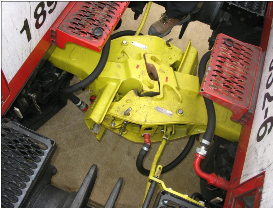
Die AK C-AKv von Faiveley ist mit der Schraubenkupplung kompatibel; Foto: Faiveley.
