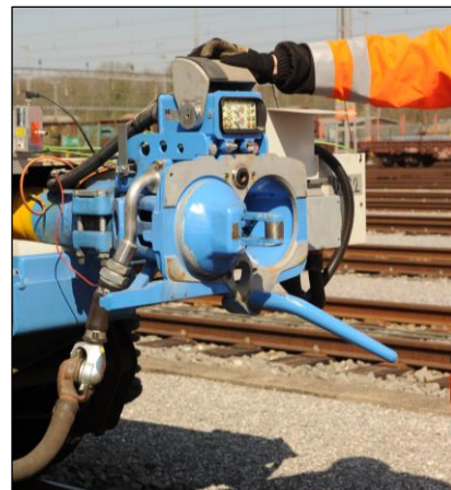
Der geöffnete neue Digital-Teil der DAK von Dellner. Man beachte, wie hoch dieser Teil über die Kupplung herausragt. Damit ist eine Verwendung im Personenverkehr ausgeschlossen. Die Anordnung des Digital-Teils Unterhalb der Kupplung ist bedingt durch die Holme nicht möglich; Foto: Jürg. D. Lüthard, 23.03.2022.
