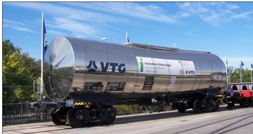
Ein 2 Meter kürzerer Kesselwagen bei gleichem Volumen ist Teil des Forschungsprojekts „Aufbau und Erprobung von Innovativen Güterwagen“ des BMVI; Foto: Gunther Ellwanger.
