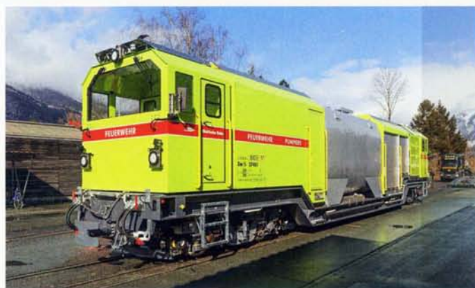
Von vorne in Fahrtrichtung links: Führerstand, Mannschaftsraum, Wassertank, Geräteschränke, Motorraum und zweiter Führerstand.
