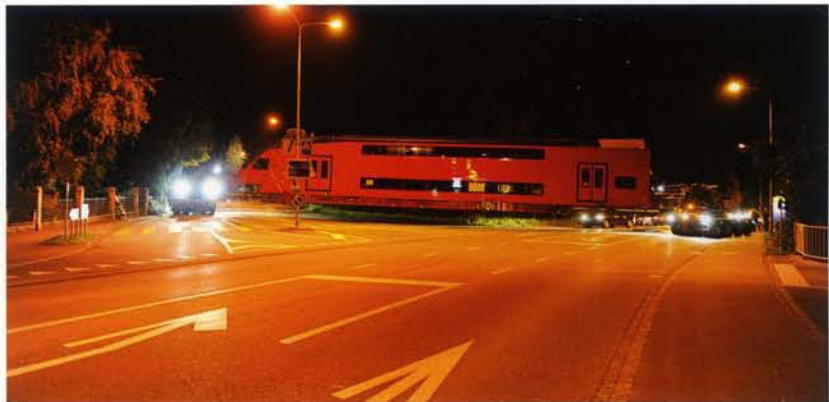
Mit über 50 Metern Länge stellte der Transport der Wagenkästen die Verantwortlichen bei der Durchquerung von Ortschaften vor einige Herausforderungen.
