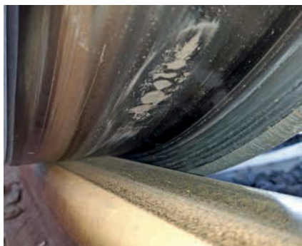
Flachstelle auf Radlauffläche
