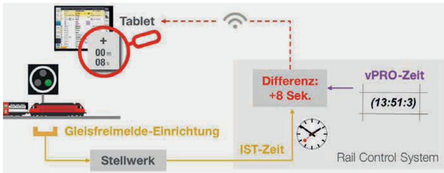
Datenfluss von der Gleisfreimelde-Einrichtung bis zur Anzeige auf dem Tablet
