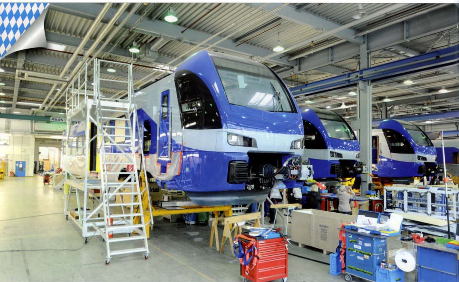
Blick in das Stadler-Werk Pankow – Meridian-Flirt in der Endmontage.
