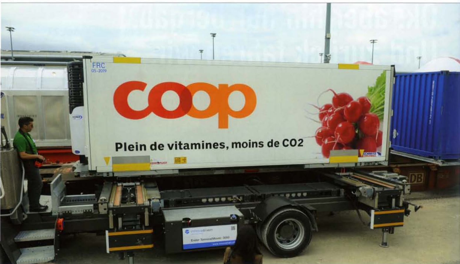
Innerhalb der Schweiz findet schon jetzt umfangreicher unbegleiteter kombinierter Verkehr statt. Es stehen mehrere technische Systeme zur Verfügung. Mit dem System von Innovatrain lassen sich mit einem entsprechend ausgerüsteten Lkw Container und Wechselbrücken seitlich auf die Bahnwagen schieben.
