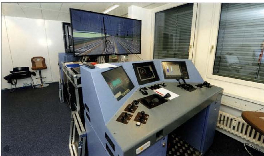
Die beiden zerlegbaren mobilen Simulatoren mit dem Einheitsführerstand. Auf den drei Touchscreen-Monitoren lassen sich die diversen Varianten anzeigen.
