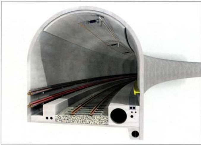
Links an der Tunnelwand, die 2-mal 3 Kabel für die 380-kV-Leitung. Rechts der Fluchtweg und die darunter liegende Frischluftversorgungsleitung zu den Schutzkavernen. © Foto: Grimseltunnel
